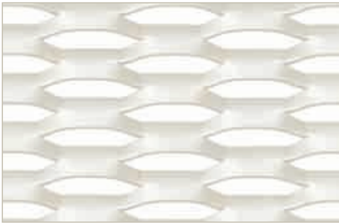
Maglia/Mesh: FILS 21 45 x 15 (13,4) - 5 x 1,5 mm (Pag. 90) Acciaio al carbonio Sendzimir verniciato/Powder coated pre-galvanized steel
