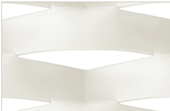
Maglia/Mesh: AMBASCIATA 110 x 40 (52) - 24 x 1,5 mm (Pag. 95) Alluminio anodizzato/Anodised aluminium
