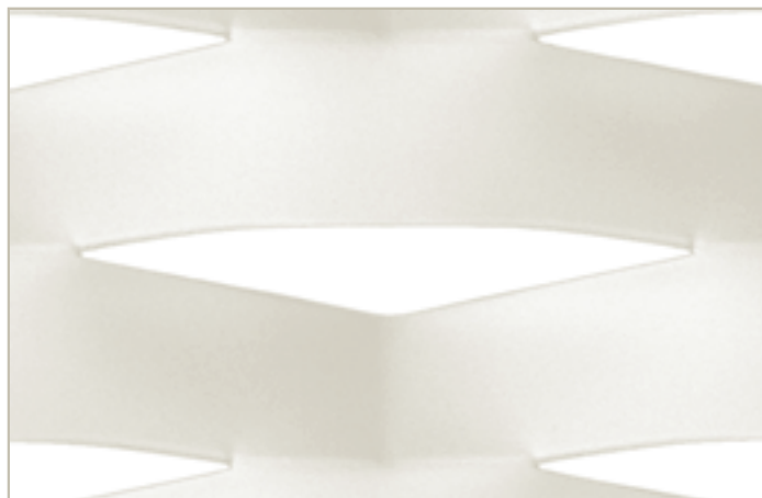
Maglia/Mesh: AMBASCIATA 110 x 40 (52) - 24 x 1,5 mm (Pag. 95) Acciaio al carbonio verniciato/Powder coated steel
