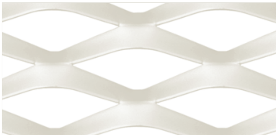
Maglia/Mesh: GATE 76 x 31 (35) - 11 x 2 mm (Pag. 92) Alluminio anodizzato/Anodised aluminium
